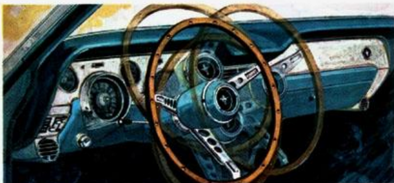
Drei Extras: Verstellbare Lenksäule, sie schwenkt zur Seite, wenn Sie die Tür öffnen (oben), Sport-Automatik (links) und Radio-Konsole (links unten).
